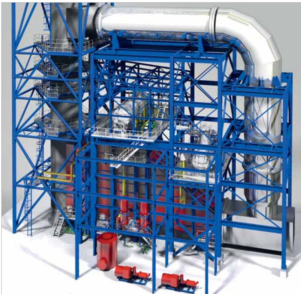
Котел-утилизатор паровой одноконтурный с естественной циркуляцией с байпасным газоходом для технологических нужд промышленных предприятий
