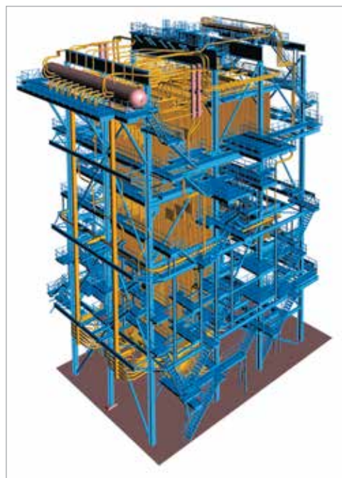
Общий вид котла паропроизводительностью 210 т/ч
