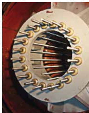
▲ Прессовка сердечника статора в горизонтальном положении
