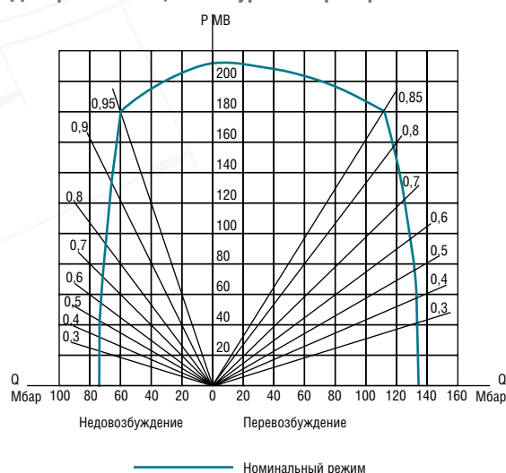
Диаграмма мощности турбогенератора ТВФ-180-2
