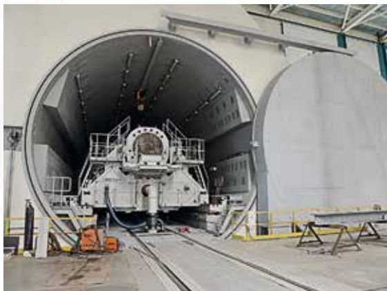
▲ Разгонно-балансировочный стенд ф. Schenck
