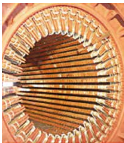
▲ Торцевая зона сердечника статора с исполнением магнитного шунта
