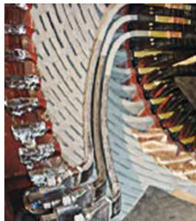
Укладка обмотки статора
