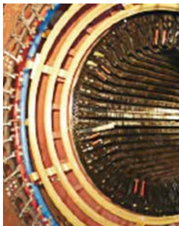
Замена кронштейнов и бандажных колец обмотки статора
