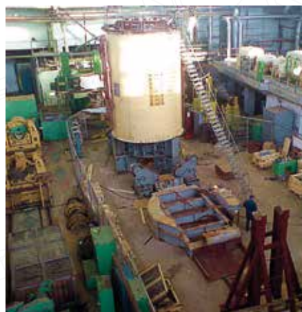
▲ Установка статора в вертикальное положение
