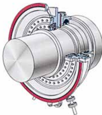
Уплотнение вала радиального (кольцевого) типа
