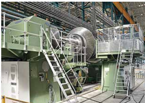
▲ Стенд облапачивания роторов ф. Georg
