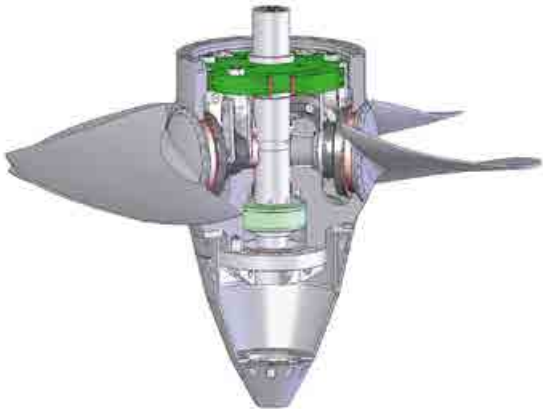
Экологически чистое рабочее колесо поворотного-лопастной гидротурбины
