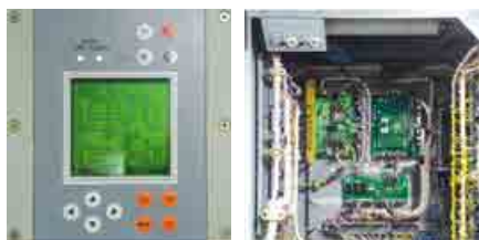
Микропроцессорная система управления преобразователем ТРПЧ
